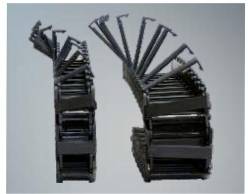
As Esteiras **PortaCabos** em nylon Série Básica são as versões mais modernas das esteiras plásticas com alças removíveis. São fabricadas em nylon reforçado com fibra de vidro, composto utilizado em plásticos de engenharia como na indústria automobilística por exemplo. Possuem alças superiores de abrir destacáveis que facilitam a montagem e/ou manutenção dos cabos, sem que seja necessário passa-los por todo o comprimento da esteira.
