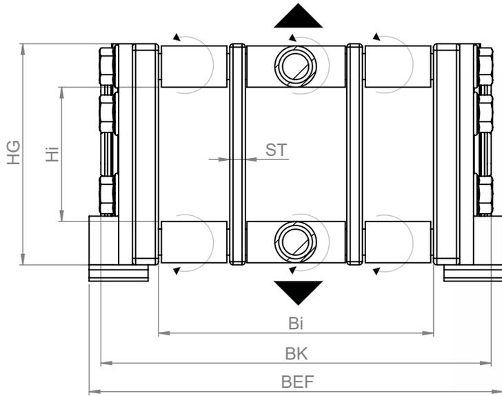
**RR:** Travessa em perfil de aço, indicada para aplicações hidráulicas e temperaturas elevadas.
