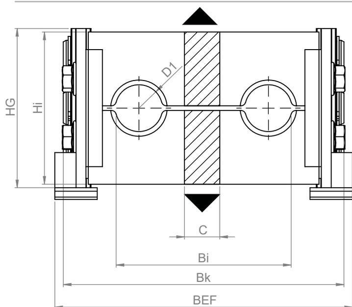
**LG:** Travessa em perfil de alumínio com cavidades usinadas, para aplicações leves e pesadas.
